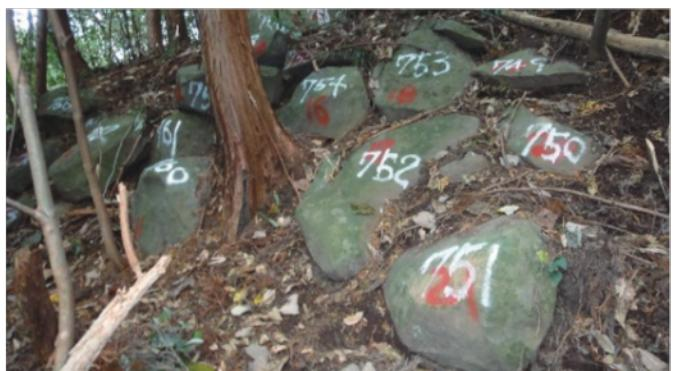
写真1.2 斜面転石状況 (直径1~2m転石多数)
