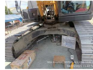
写真-10 平板載荷試験実施状況
