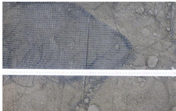
写真 3 ジオテキスタイル補強材試料の採取状況
