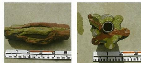
写真-2 繰返し注入による補強体の造成例
