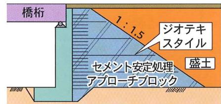
図-2 セメント改良補強土橋台の概要
