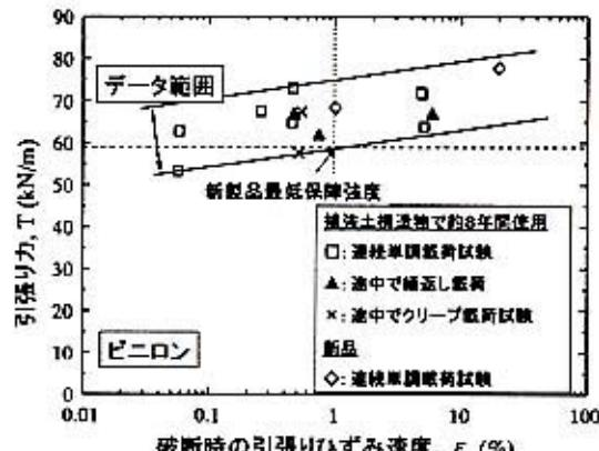
図-4 8年間使用した補強材の引張り破断強度と破断時引張りひずみ速度の関係の例(Hirakawa et al., 2003)
