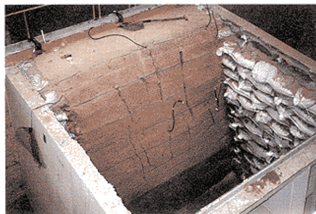
写真-3 振動実験終了後の解体状況
