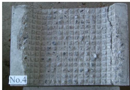
室内剥離試験後の試験片(二軸PVAグリッド)
