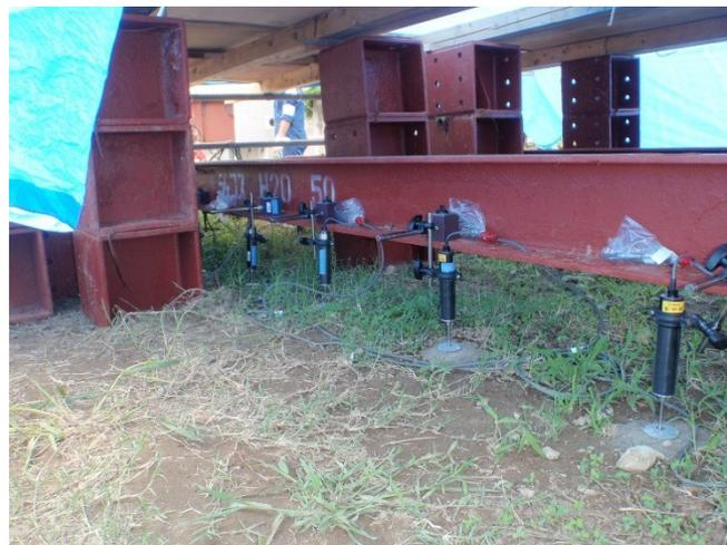
鉄道総合技術研究所内の盛土試験場にて施工時の軌道変状の検証試験を実施した
