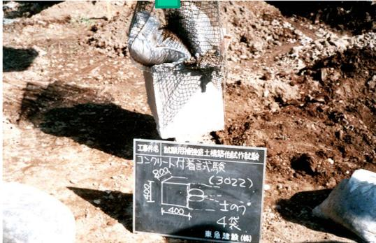
実際の壁面工から切り出した試験体
