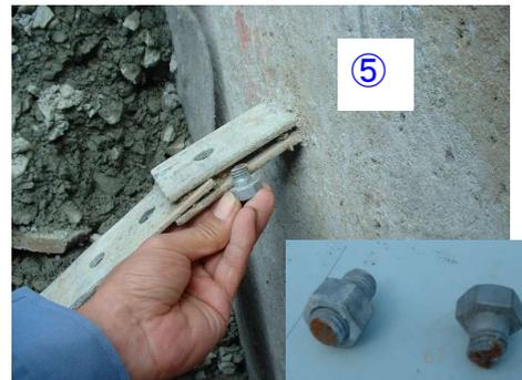
これは、一部のパネルが崩壊すると、擁壁全体の崩壊に発展した事例での崩壊メカニズムを説明したものです。
