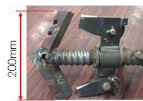
攪拌混合装置(中径:開翼時)
