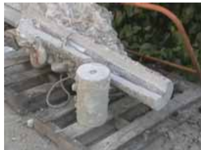
掘り出したキャロット補強体
