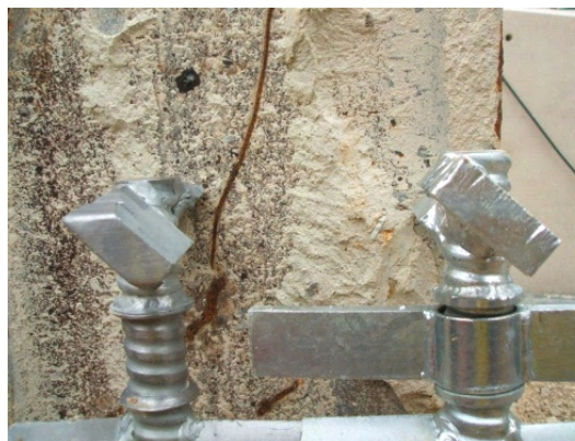
写真3.2 自穿孔型ラディッシュアンカー掘削翼 (左側:掘削不能となった掘削翼、右側:標準型掘削翼)
